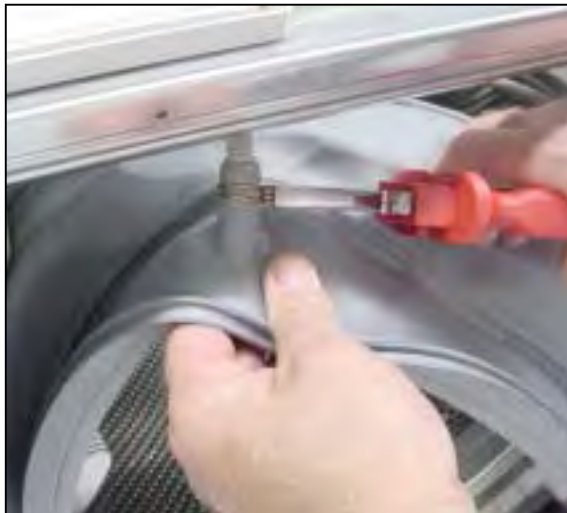
Remove door seal
