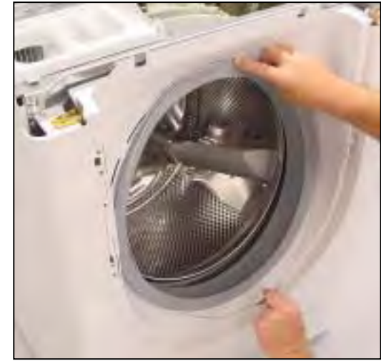
Remove door seal spring
