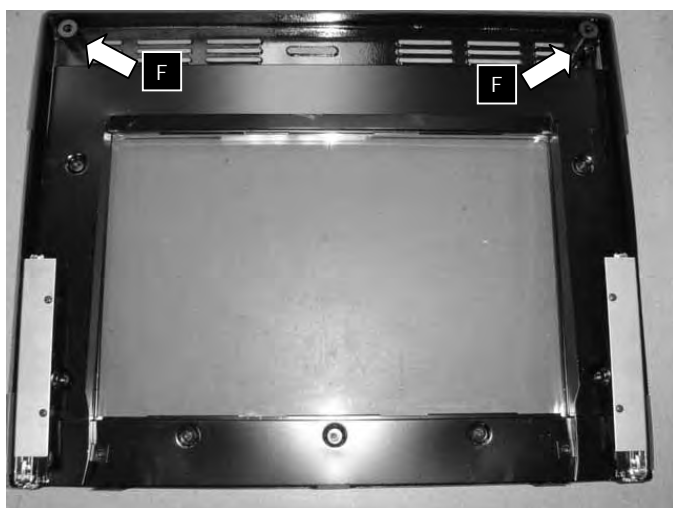
Door Spacer Placement
