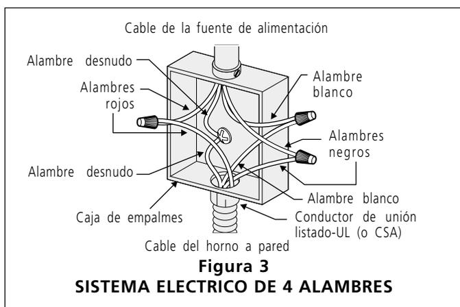
**⚠️ PRECAUCION** Si está conectado a un sistema eléctrico de 4 alambres, el armazón del electrodoméstico NO TIENE QUE estar conectado al alambre neutro del sistema eléctrico de 4 alambres.
