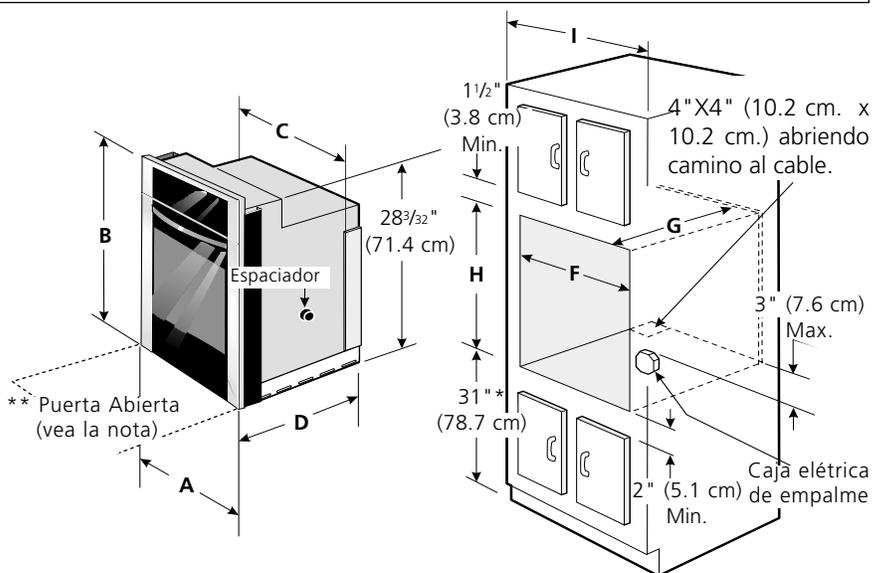
**NOTA:** Para la instalación combinada de este Horno Empotrable con Cajón Asador Modelo **E30WD75DSS** ver las dimensiones especificadas en las instrucciones de instalacion del Cajón Asador.
