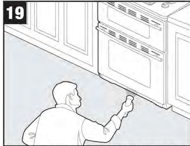
19 Check leg position in bracket./Vérifiez que le pied est bien sous la bride./ Verifique la posición del tornillo en el soporte.
