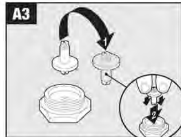
Rotate pin and snap pin firmly into place./Tournez la cheville et enclenchez fermement la cheville en place./Gire el pasador y encájelo en su lugar.
